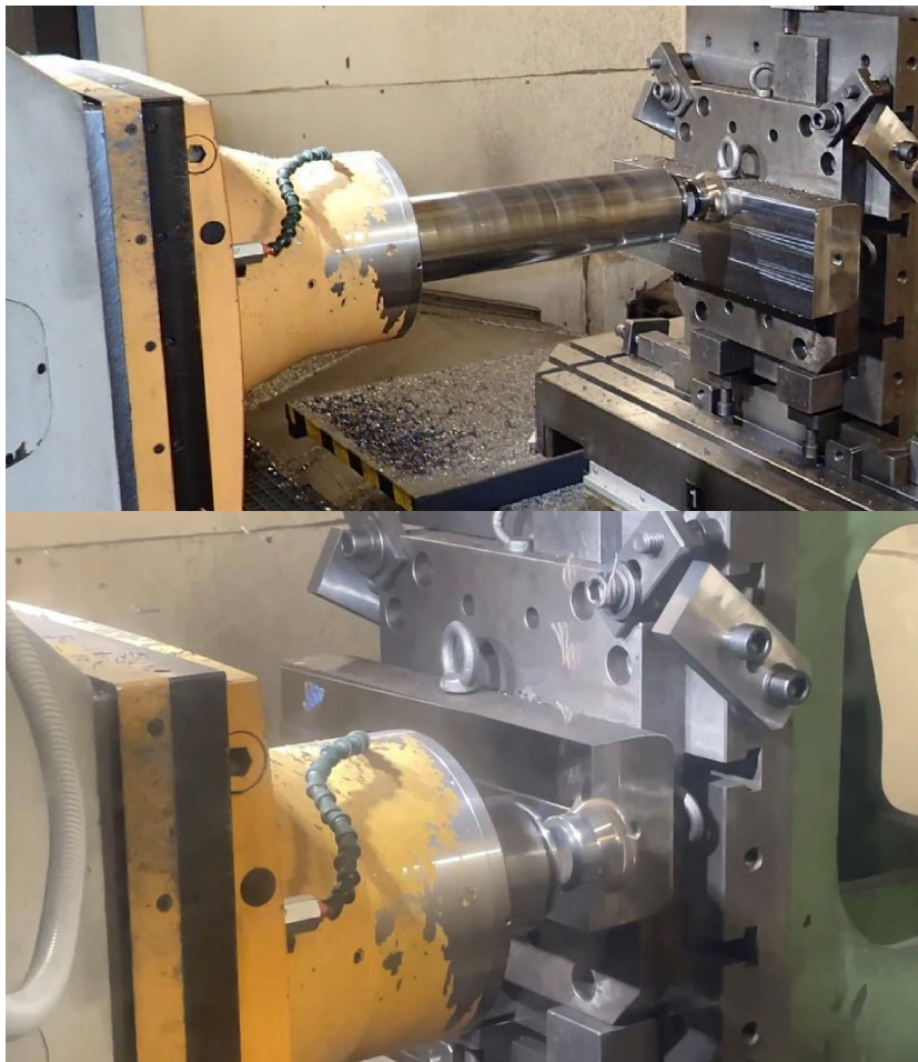
Obr. 67: Příklad obráběcích operací pro čelní frézu
