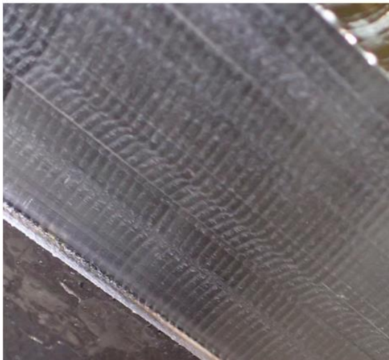
Obr. 92: Porovnání obrobené povrchu pro různé otáčky pro měření M17
