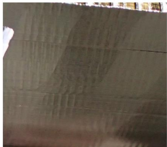
Obr. 93: Porovnání obrobené povrchu pro různé otáčky pro měření M21
