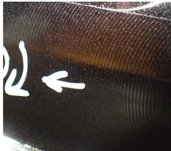
Obr. 86: Porovnání obrobené povrchu pro různé otáčky pro měření M16
