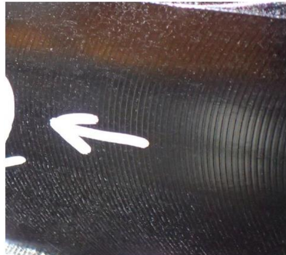
Obr. 85: Porovnání obrobené povrchu pro různé otáčky pro měření M08
