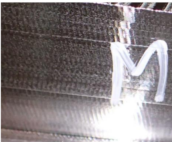
Obr. 93: Porovnání obrobené povrchu pro různé otáčky pro měření M21
