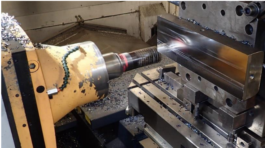
Obr. 68: Příklad obráběcí operace pro válcovou frézu
