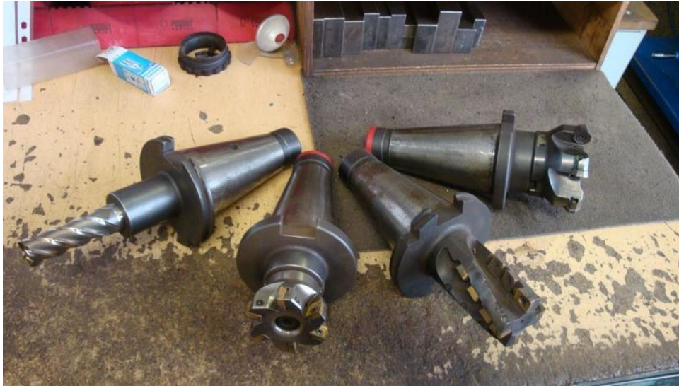
Obr. 3: Frézovací nástroje s kuželovou stopkou (Morse) [3]
