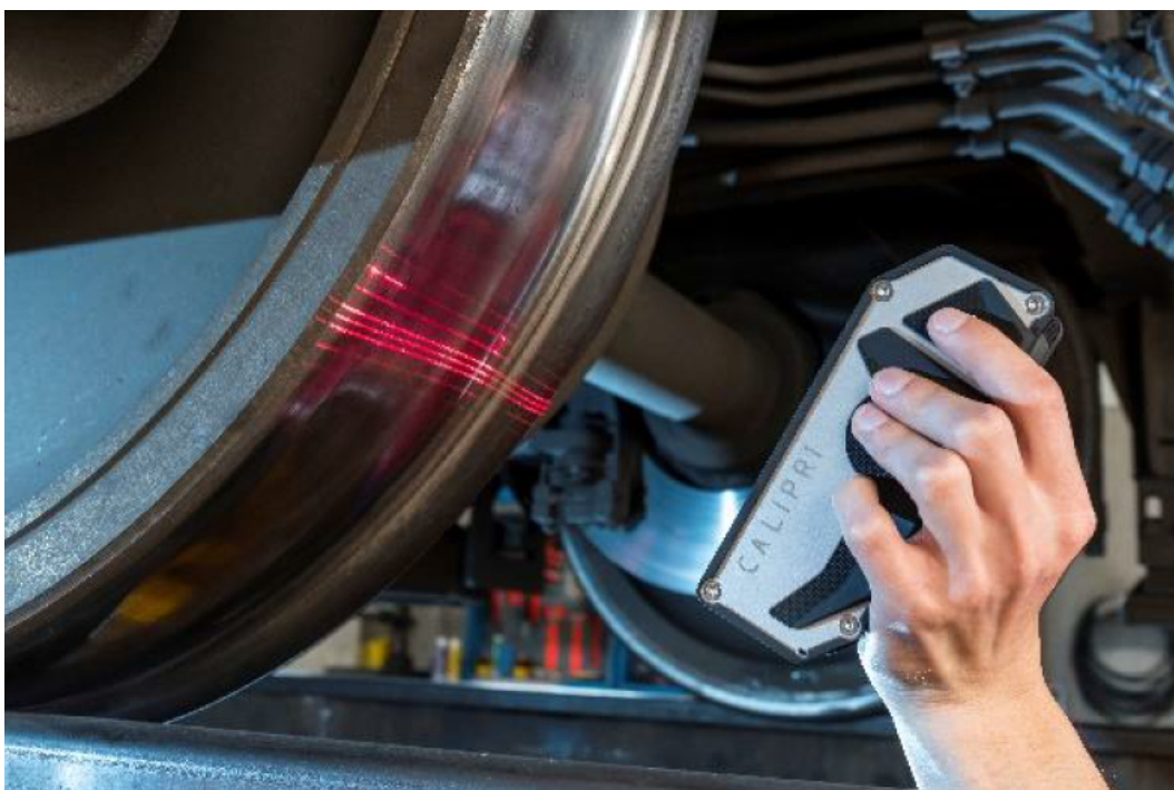
Obr. 15: Měření profilu přístrojem Calipri [17]
