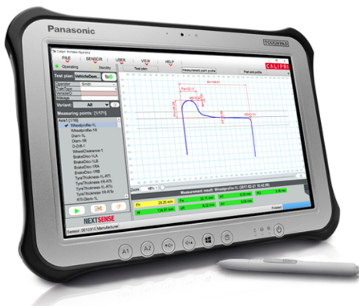
Obr. 16: Grafické zobrazení naměřených dat přístrojem Calipri [17]
