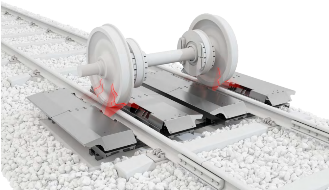
Obr. 17: Měření jízdních profilů za provozu [18]
