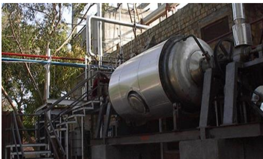
Obrázek 11: Horizontální rotační extraktor od firmy Athena Process design and manufacturing [5]
