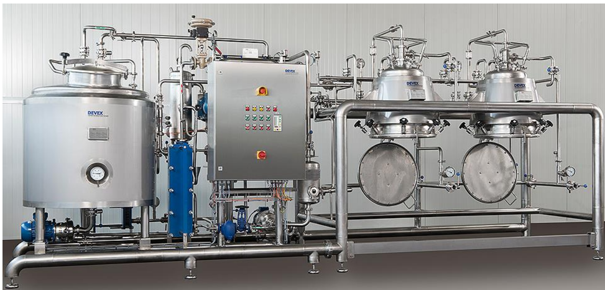
Obrázek 15: DEVEX pilotní extrakční závod 2 x 100 l extraktory pro extrakci kapalina-pevná látka různých produktů. [9]
