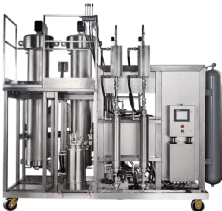
Obrázek 22: Průmyslový superkritický extraktor CDMH.100-2X-2F společnosti Isolate Extraction Systems s průtokem 20 kg/min. [28]
