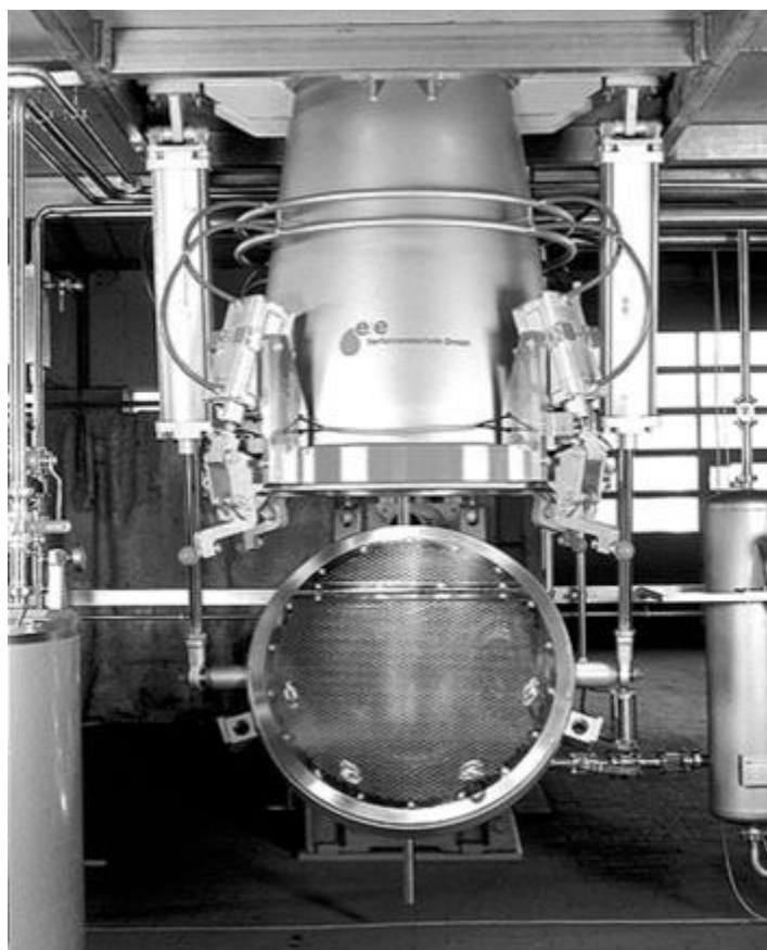
Obrázek 6: Perkolační extraktor – kapacita 1 m 3 [4]
