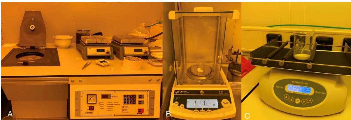
Obrázek 18: Využití laboratorní vybavení: (A) spin coater KarlSuss CT60, (B) váha Denver Instrument S-64, (C) Orbital Shaker PSU-10i.
