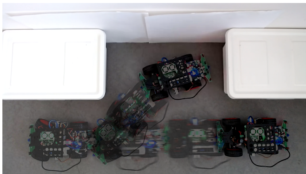
■ Obrázek 4.5 Částečně úspěšné parkování. Parkovací prostor dlouhý 47 cm. Místo bylo sice vyhodnoceno správně, v tomto případě se však projevila zmíněná chybovost enkodérů při couvání a vozidlo ujelo při R^- a L^- příliš malé vzdálenosti.
