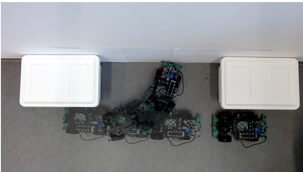
■ Obrázek 4.4 Neúspěšné parkování modelu. Parkovací prostor dlouhý 60 cm. V tomto případě došlo při R^- k chybě sériové linky.
