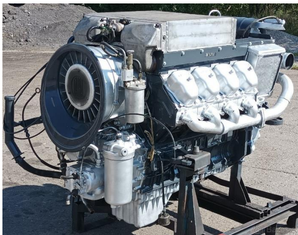
Obr. 27 Motor Tatra T3C-928-81 s přeplňováním
