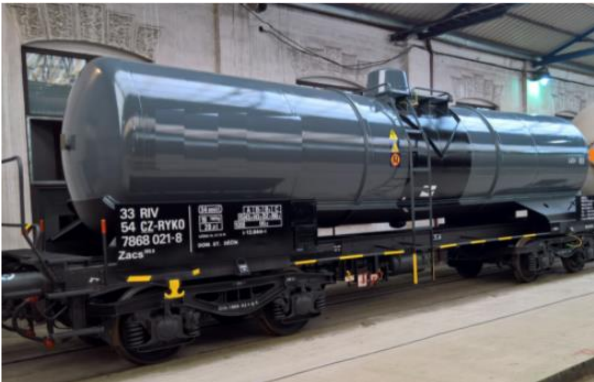
Obrázek 17: Cisternový vůz Zacs na přepravu kyselin [7]
