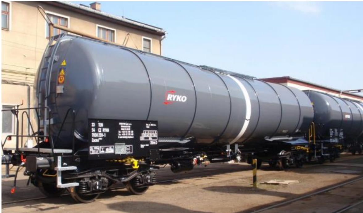
Obrázek 16: Cisternový vůz řady Zacns na přepravu ropných látek [7]
