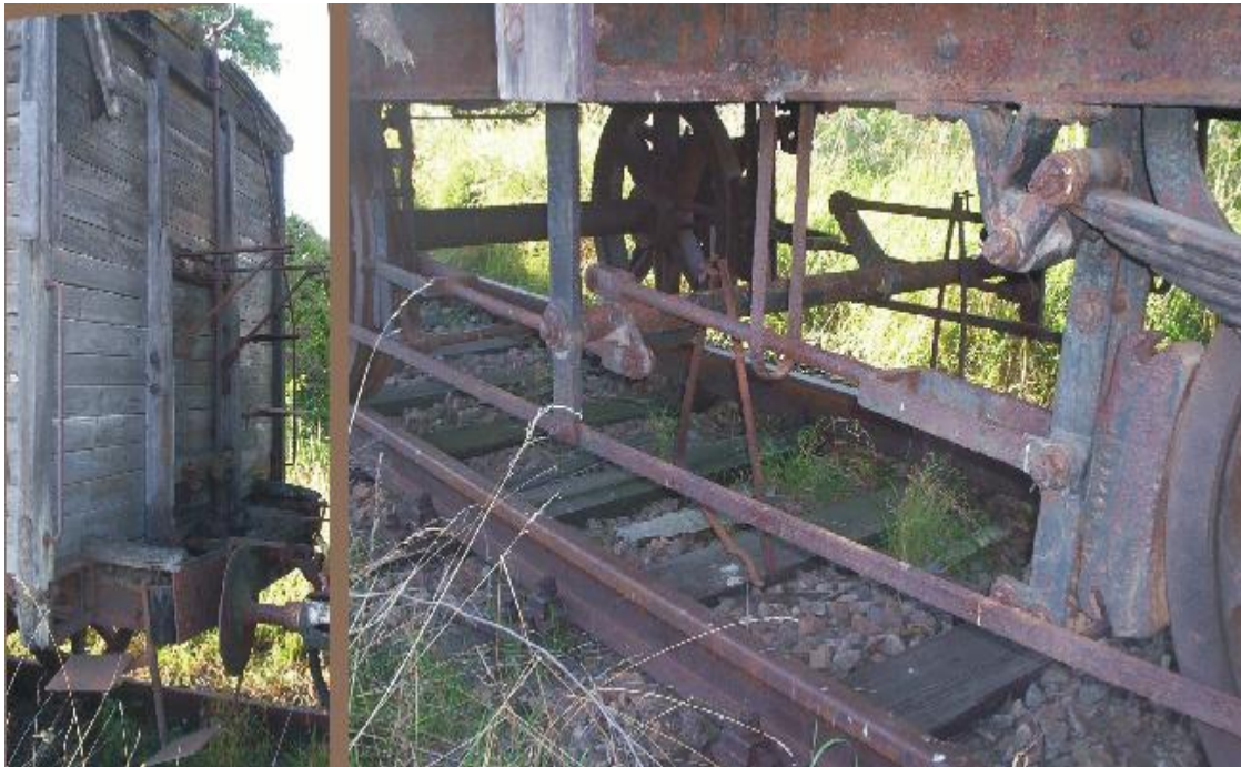
Obrázek 25: Konzola brzdařské plošiny (vlevo), mechanický převod a celistvé zdrže (vpravo) [5]
