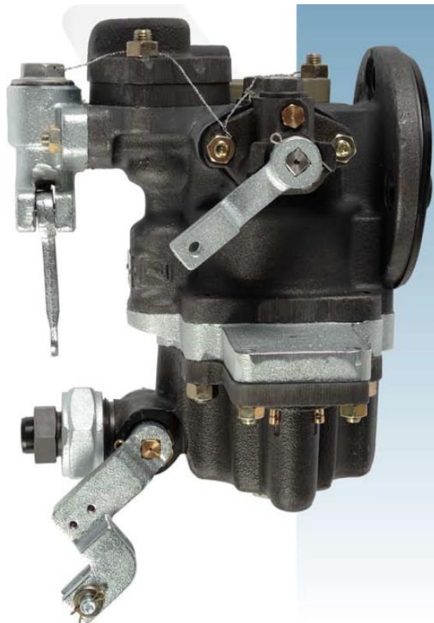
Obrázek 35: Rozváděč DAKO CV1nD [13]
