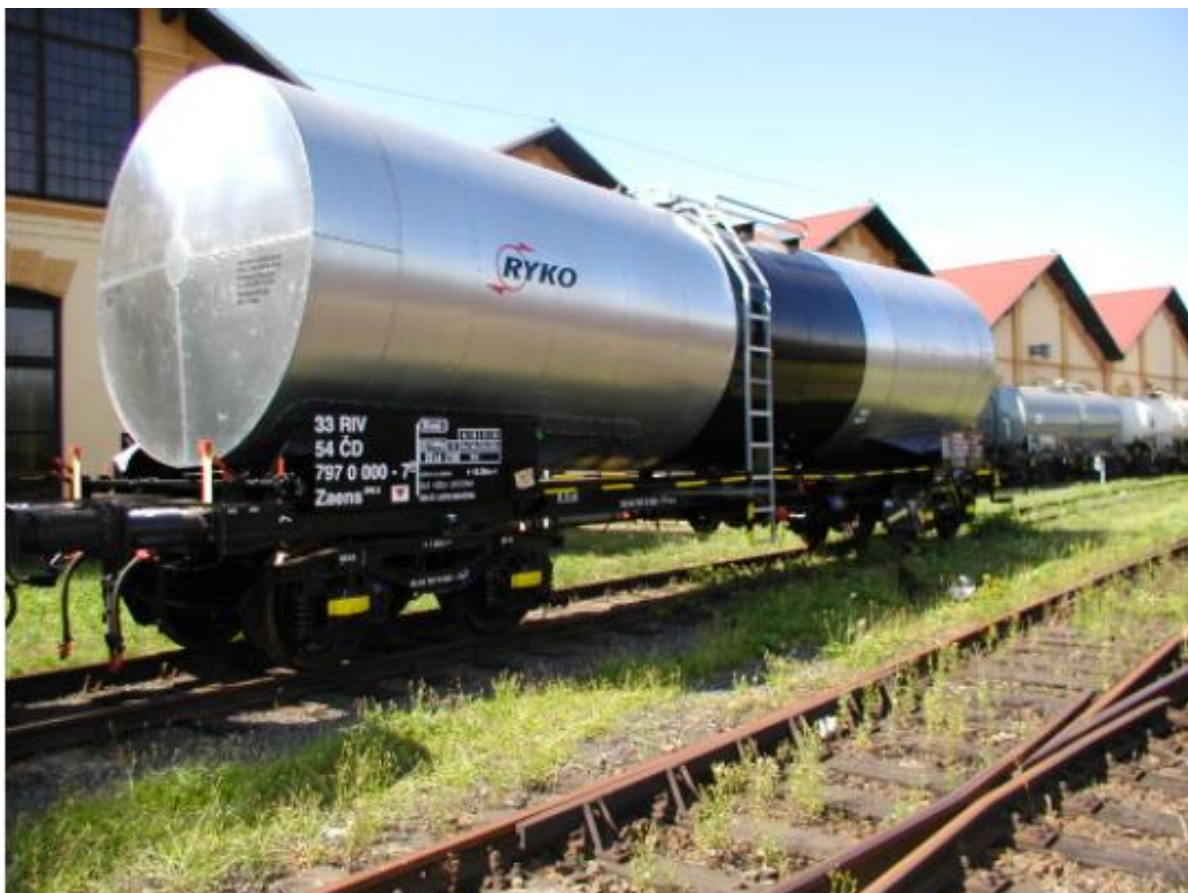
Obrázek 15: Cisternový vůz Zaens na přepravu olejů a ropných derivátů [7]
