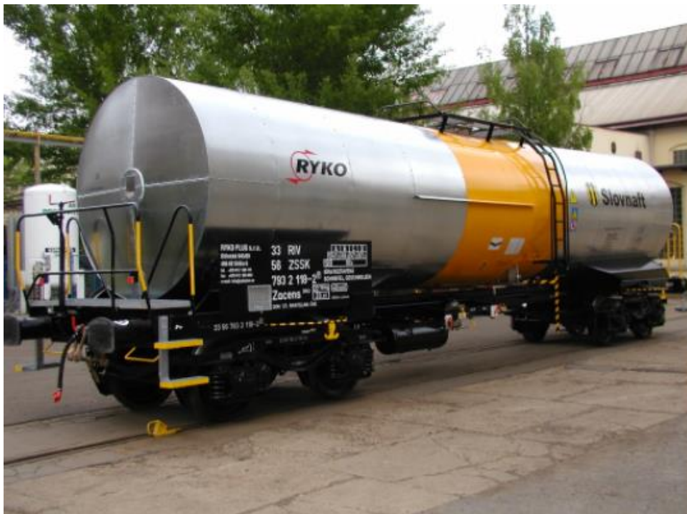
Obrázek 19: Cisternový vůz Zacsens na přepravu tekuté síry [7]
