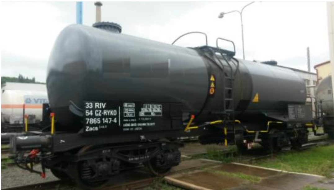
Obrázek 18: Cisternový vůz Zacs na přepravu žíravých látek [7]
