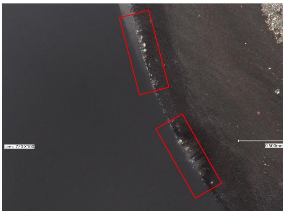
Obr. 54- Opotřebení nástroje s odlomenými kusy zubu.
