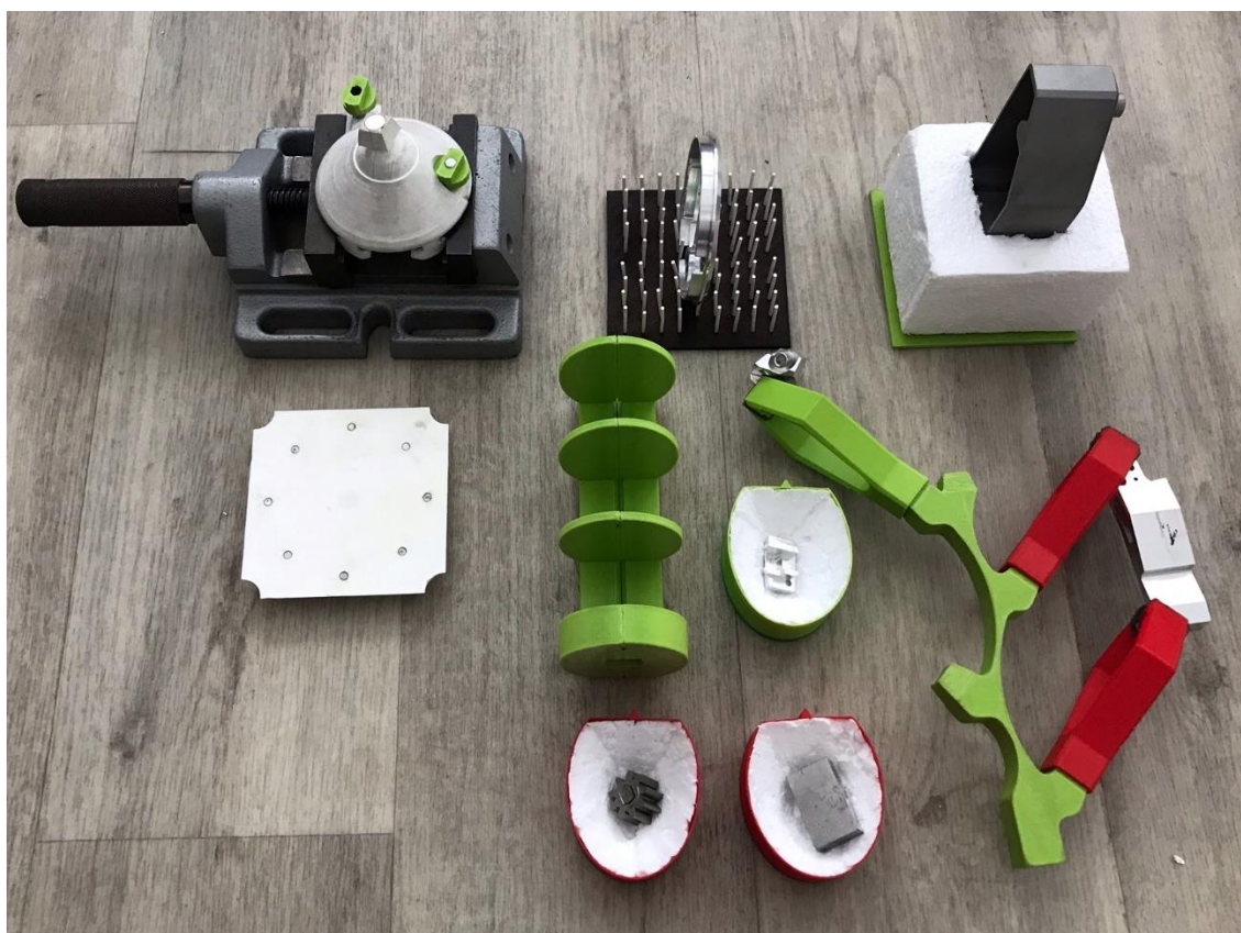
Obrázek 19 - Upínací systém včetně vybraných upínačů a nástavců
