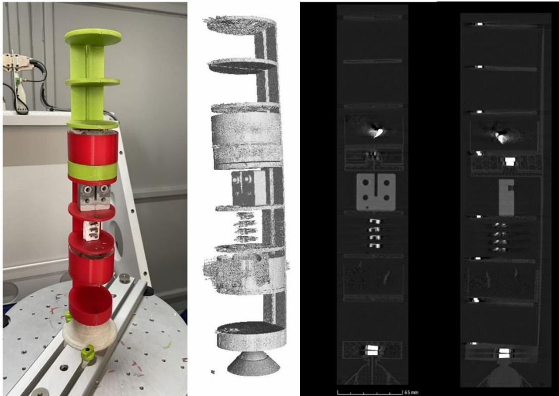
Obrázek 28 - Pohled na upnuté zkušební artefakty a naskenovaná data
