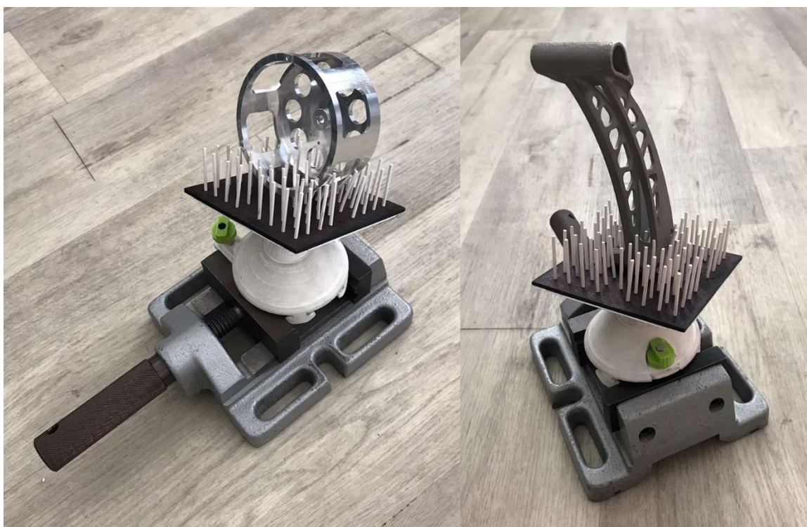
Obrázek 21 - Upnutí součásti pomocí upínače "ježek" s trny z materiálu ABS
