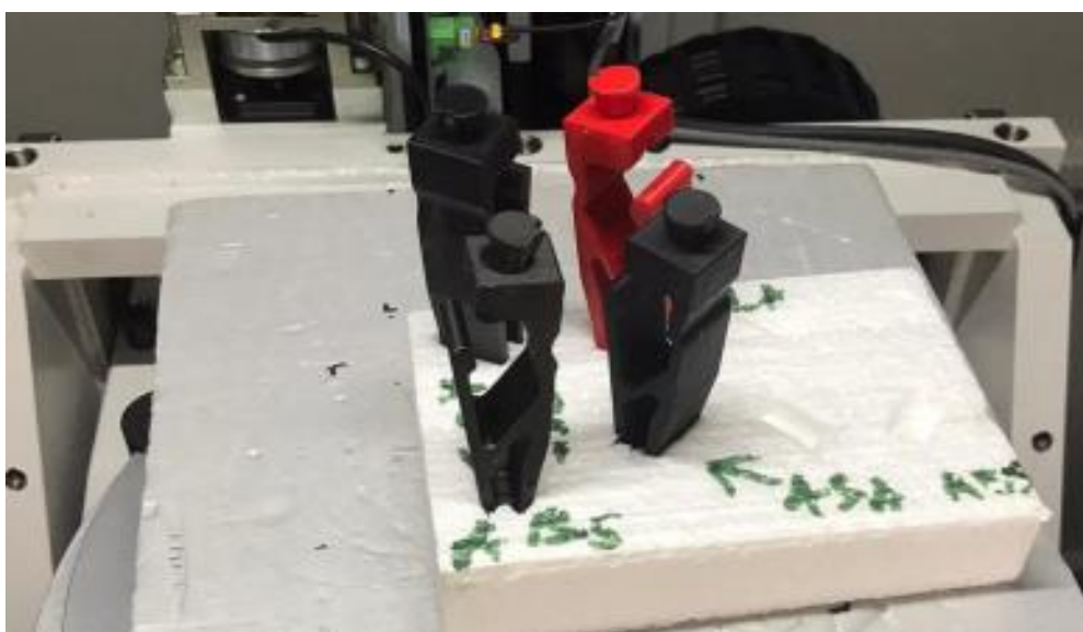
Obrázek 10 - zafixování měřených předmětů "zapíchnutím" do bloku polystyrenu
