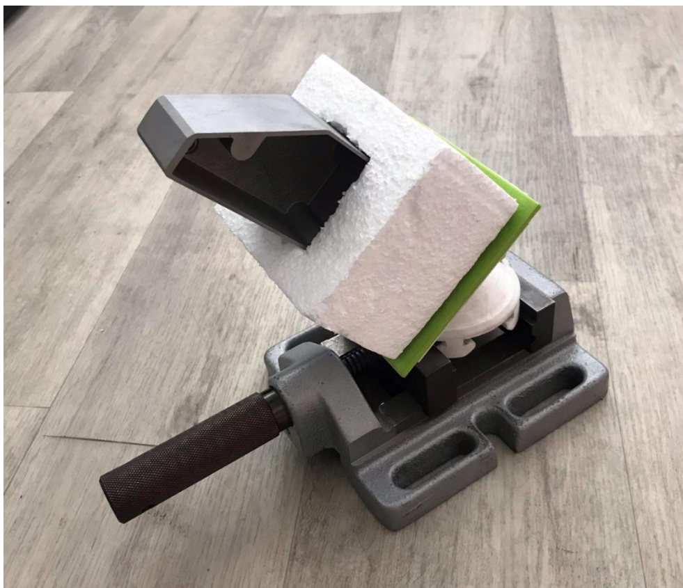
Obrázek 20 - použití upínače s uhlíkovými trny pro napolohování a zafixování dílců upnutých v bloku polystyrenu
