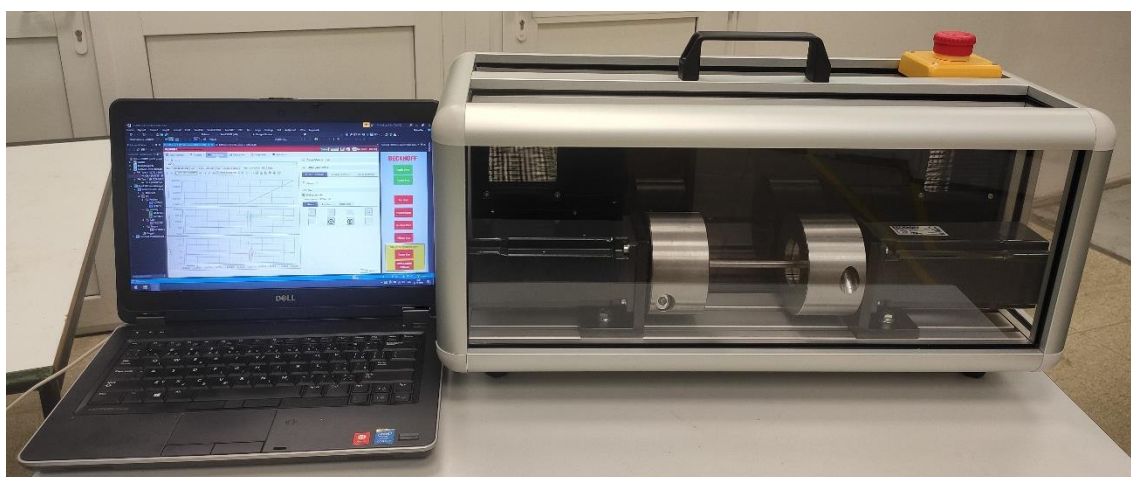
Obrázek 7-20 – Stand pro výuku servopohonů včetně řídicího notebooku
