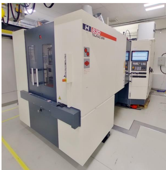
Obr. 73 Fotografie horizontálního frézovacího centra H630 od firmy TAJMAC-ZPS
