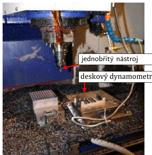
Obr. 43 Fotografie pracovního prostoru v průběhu experimentu [35]
