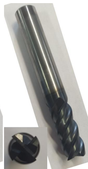
Obr. 75 Fotografie frézy EC120B25-4C12 IC900 od výrobce ISCAR
