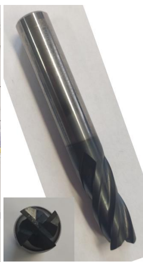
Obr. 74 Fotografie frézy EC120A25-4C12 IC900 od výrobce ISCAR
