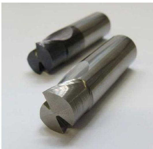
Obr. 44 Fotografie jednobřitých fréz v povlakované (vlevo) a nepovlakované (vpravo) variantě
