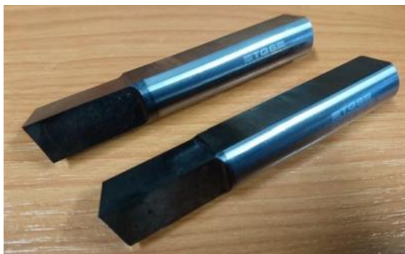
Obr. 38 Ilustrační fotografie použitých monolitických soustružnických nožů (TGS nástrojárna) [33]
