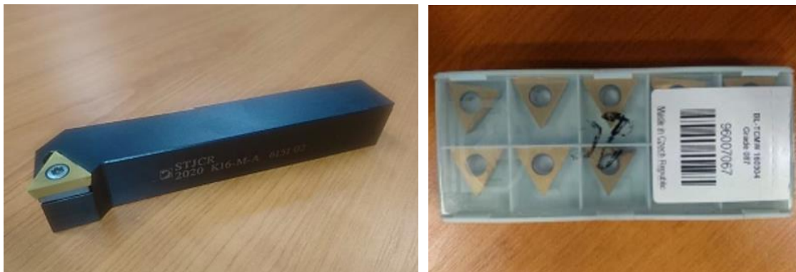
Obr. 40 Fotografie použitého držáku STJCR 2020 M 16-M-A a výměnné břitové destičky TCMW 16T308 od firmy PRAMET [28]
