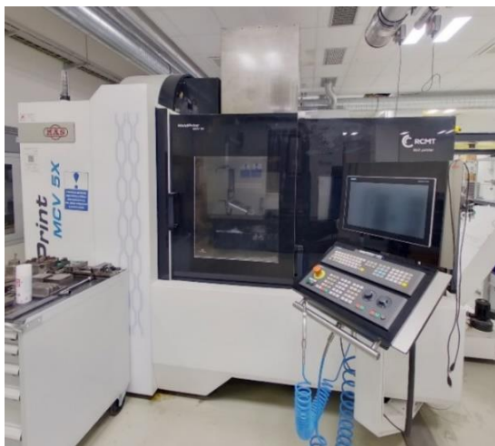
Obr. 80 Hybridní stroj Weldprint 5AX od firmy Kovosvit MAS
