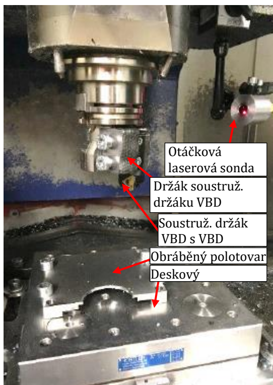
Obr. 46 Fotografie pracovního prostoru s držákem soustružnického držáku VBD
