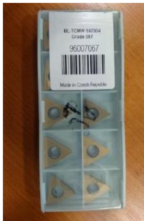
Obr. 47 Fotografie použitých výměnných břitových destiček
