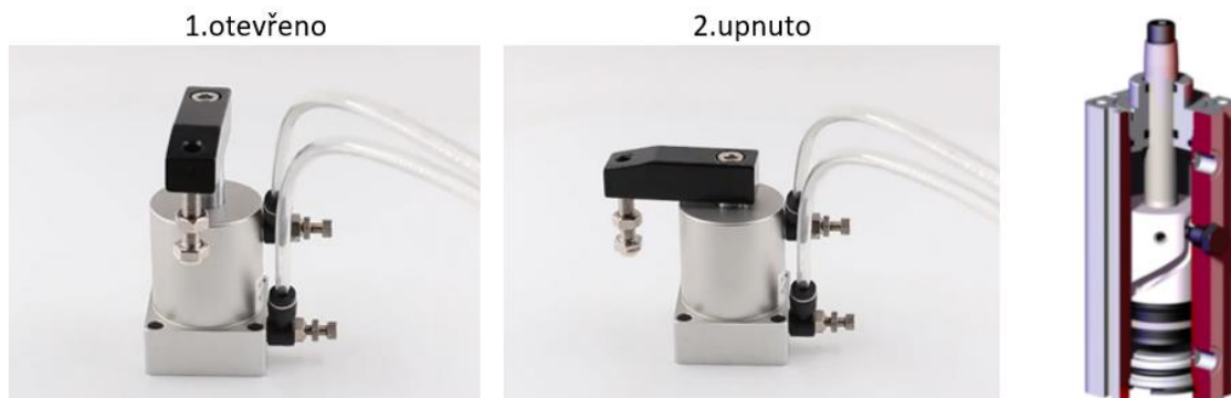
Obrázek 3.16: Princip otočných pneumatických upínek [52,53]
