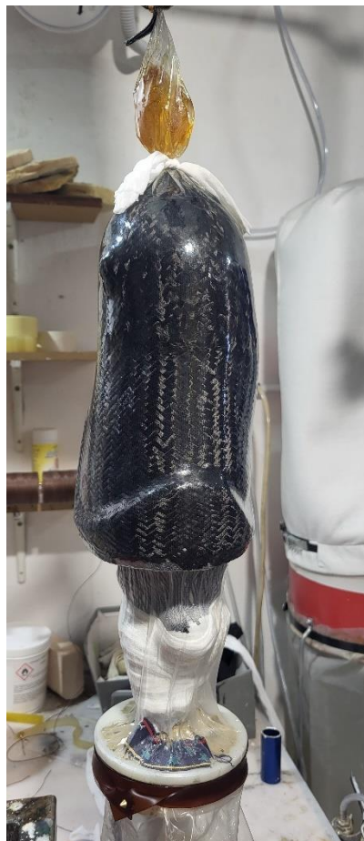
Obrázek 17: Proces vrstvení uhlíkového vlákna a laminování vnější vrstvy lůžka [25]
