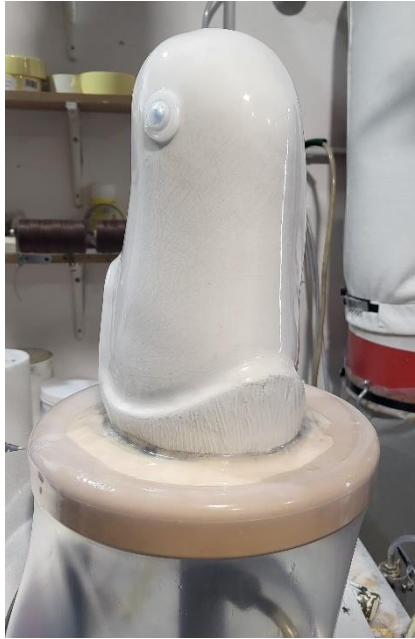
Obrázek 16: Proces natahování vnitřní vrstvy lůžka [25]
