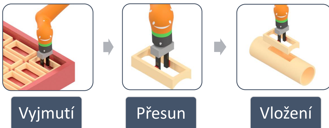
Obrázek 50 Přesun lepené součásti z přípravku na KKV
