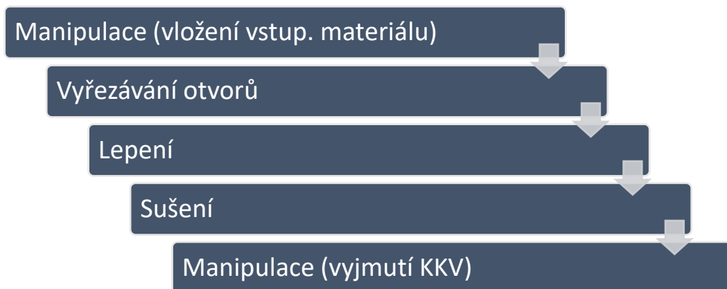
Obrázek 25 Proces lepení KKV
