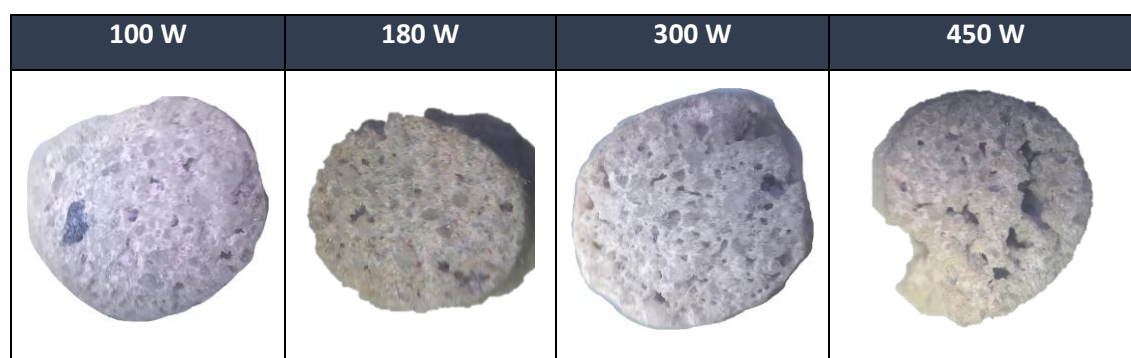
Tabulka 8 Snímky výbrusů tmelových housenek při různých výkonech sušení
