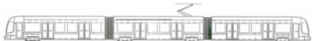
Obr. 6 - Schéma článkového provedení nízkopodlažní tramvaje s otočnými podvozky [1]
