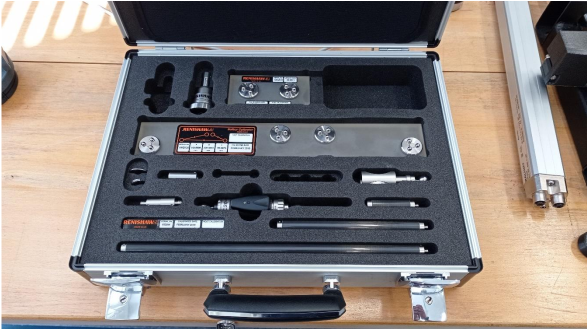
Obr. 63 Kufř měřidla Renishaw BallBar QC20 spolu s kalibračním etalonem
