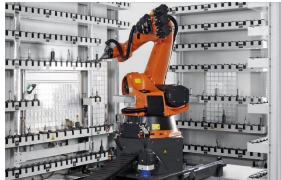
Obr. 53: velkokapacitní zásobník nástrojů Demmeler[34]
