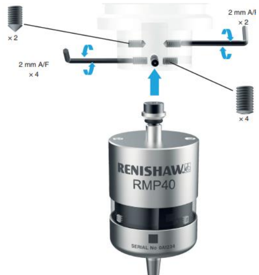
Obr. 12: seřízení sondy [7]
