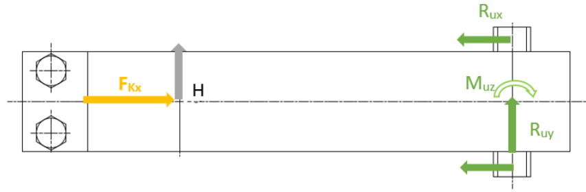
Obr. 30: Síly působící na kyvné rameno v rovině XY
