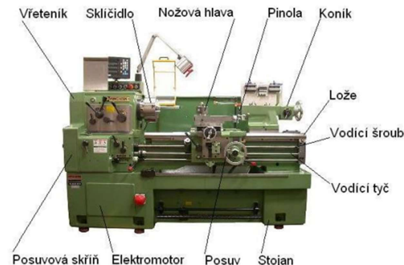
Obrázek 1 - konvenční soustruh [33]
