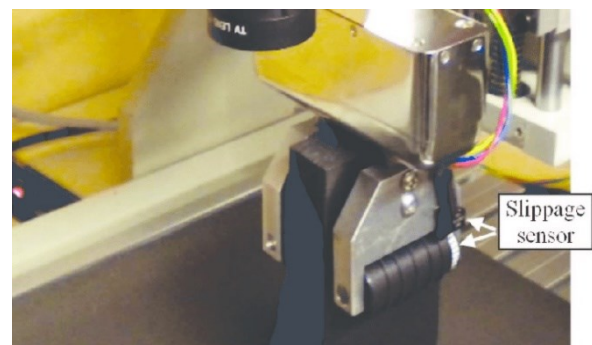
Obr. 20 - Třecí senzor prokluzu [44]
