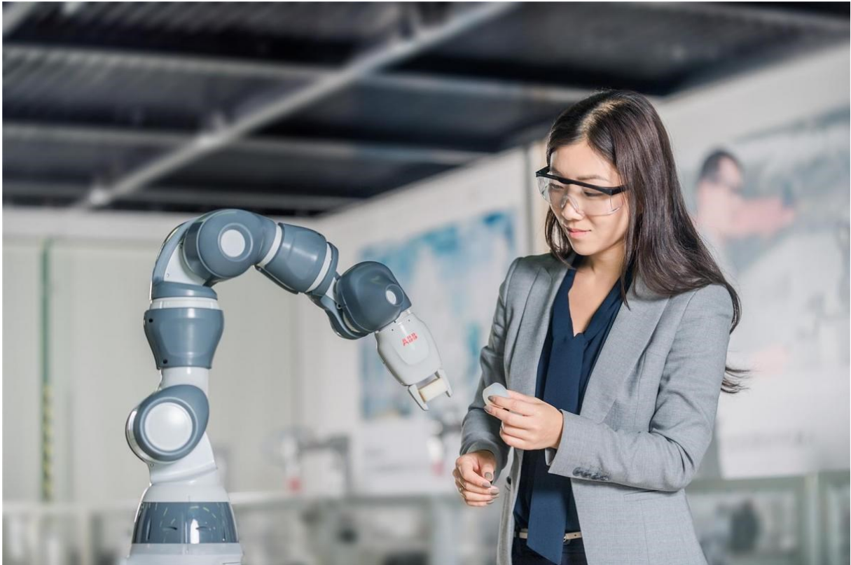
Obr. 8 – Spolupráce člověka s kolaborativním robotem ABB Yumi [18]
