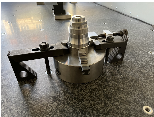
Obr. 18: Upnutí součásti ve stroji
