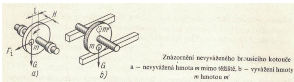
Obr. 26 - Problematika statického vyvažování [1]
