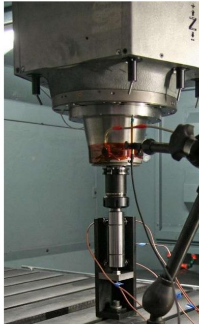
Obrázek 10 – Zkouška teplotních deformací způsobených rotací vřetena [7]
