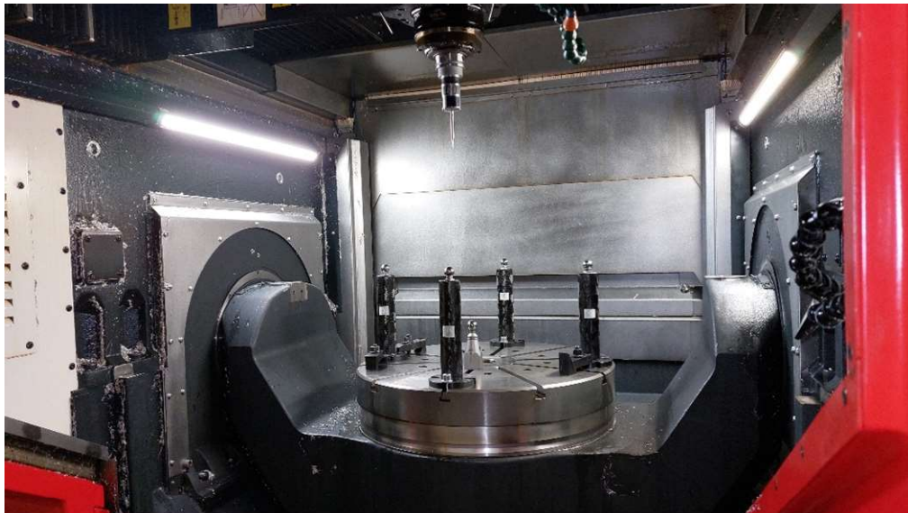
Obrázek 23 – Zkušební kulové přípravky při měření teplotních deformací [7]
