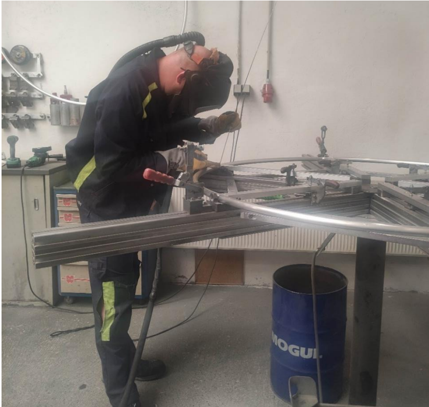
Obrázek 15 – Škodlivá poloha pracovníka při svařování způsobena nízkým přípravkem [vlastní fotografie]
