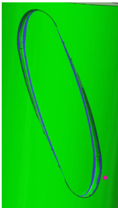
Obr. 79 Výsledky simulace 4D obrábění, nastavená tolerance 0,2 mm
