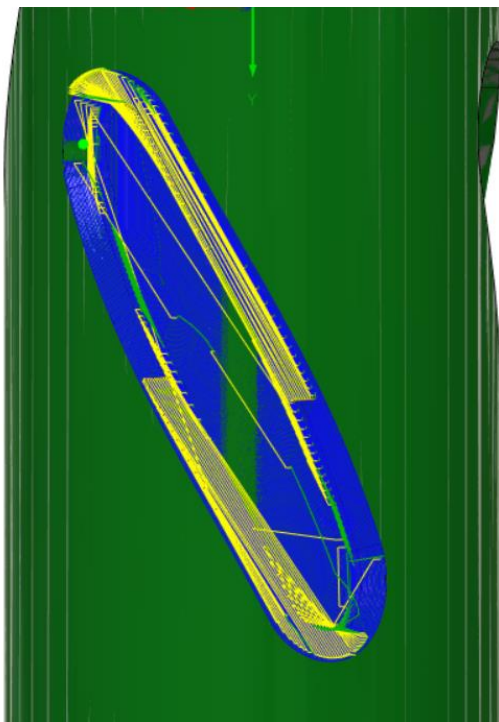
Obr. 71 Dráha nástroje u dokončování s metodou 3+2D (Steep and Shallow + Tool orientation)
