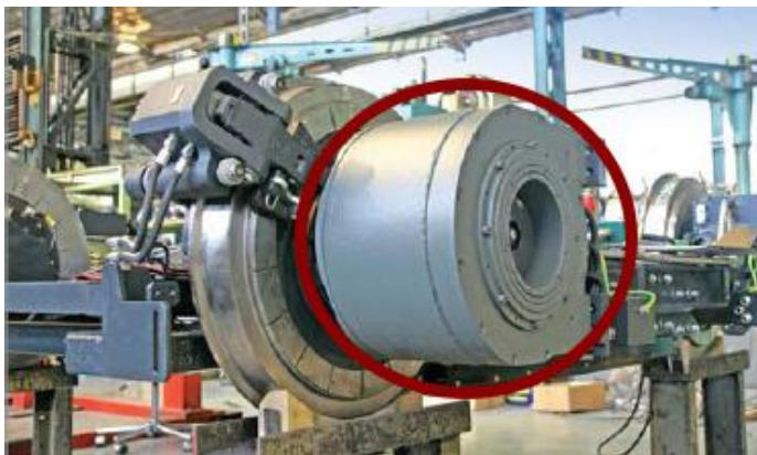
Obr. 6 – Elektromotor s kotoučovou brzdou, [18]
