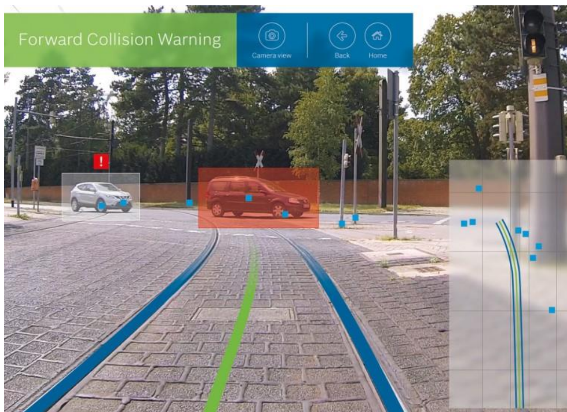
Obr. 4 – Virtuální tunel vytvořený před tramvají antikolizním systémem od společnosti Bosch Engineering, [26]
