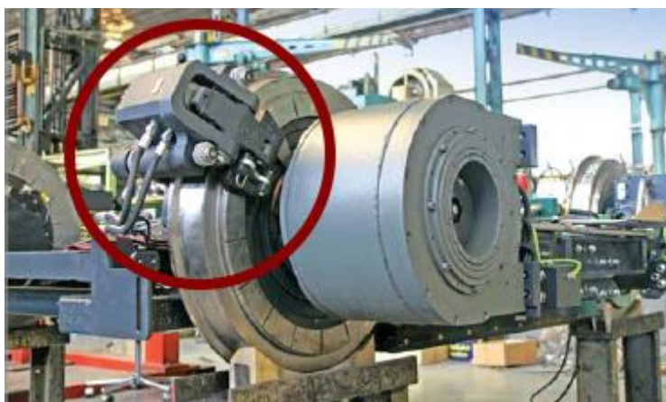
Obr. 9 – Kotoučová brzda s elektromotorem, [18]
