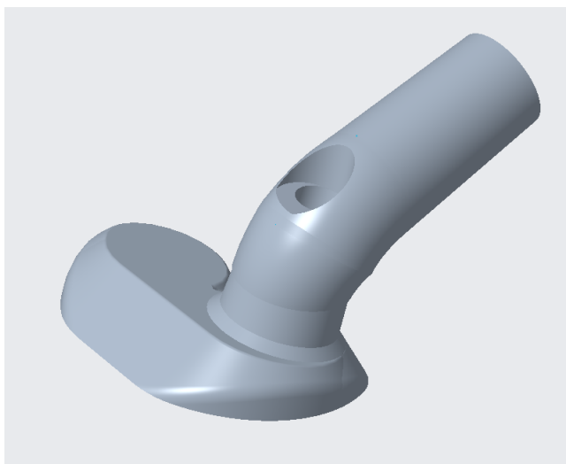
Obr. 16: Odečítání ventilového pouzdra a indentace kanálu pro možnost jeho ukotvení
