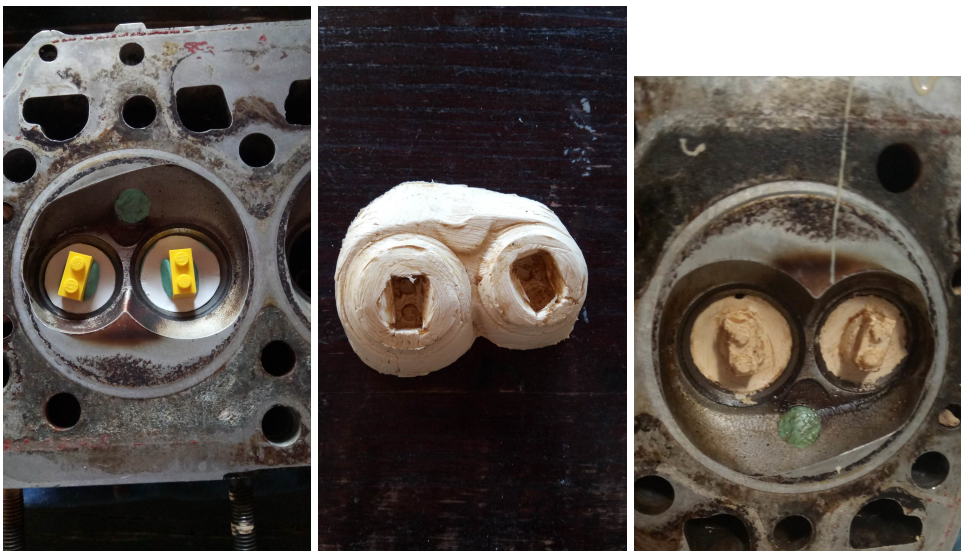
Obr. 8: Tvorba oporné geometrie pro správné pozicování dílů odlitku (Poka-yoke) pomocí stavebnice LEGO (vlevo)
