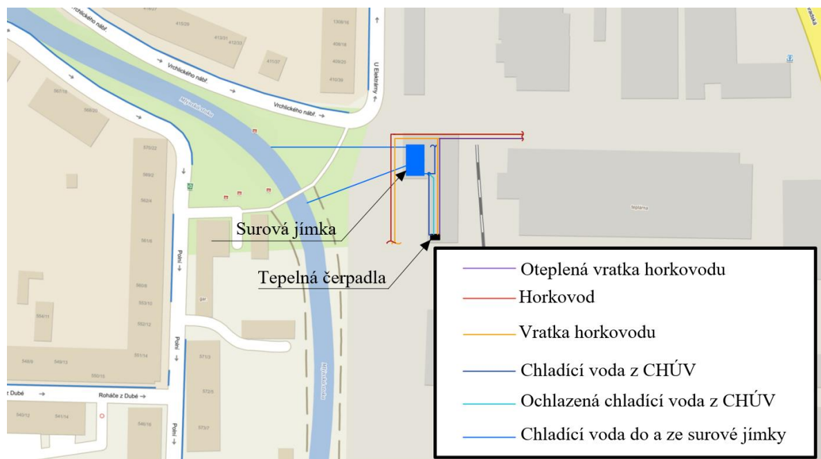
Obrázek 16: Jednoduché situační schéma zapojení tepelných čerpadel do prostoru CHÚV
