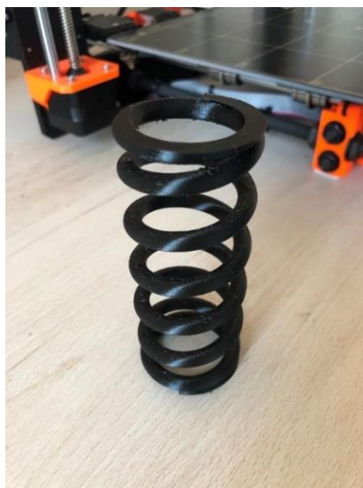
Obr. 25 – Vytištěná pružina od Ing. Lukáše Kazdy z materiálu PLA
