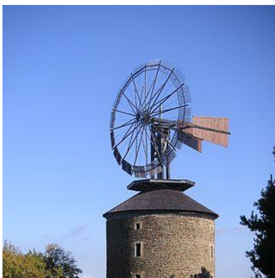
Obr. 12 Příklad Halladayovy (mnoholopátkové) turbíny
