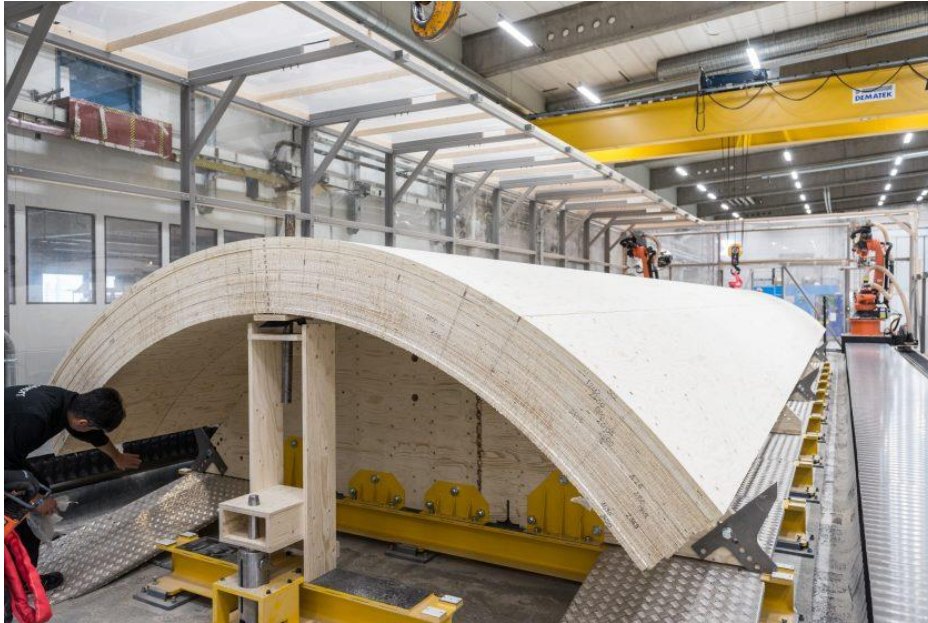
Obr. 30 Ohnutý LVL panel připravený k obrábění
