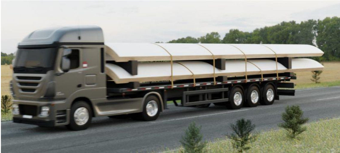
Obr. 34 Způsob dopravy ohnutých LVL panelů
