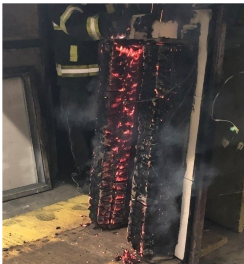
Obr. 38 – Vzorky po ukončení zkoušky a vyjmutí z pece
