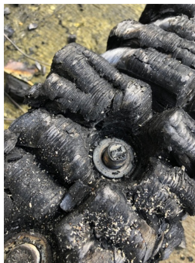
Obr. 39 – Vzorek po uhašení v kádi s vodou
