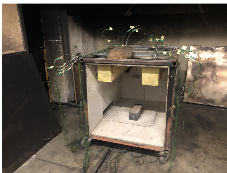
Obr. 20- Zkušební pec miniFUR
