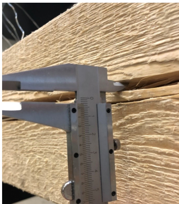
Obr. 25 – Šířka výsušné trhliny vzorku 1
