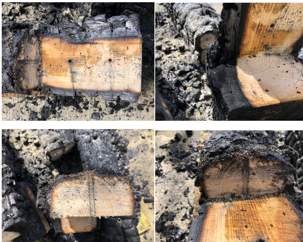
Obr. 44 – Řez v místě svorníku vrutu \varnothing 8 mm – Vzorek 2
