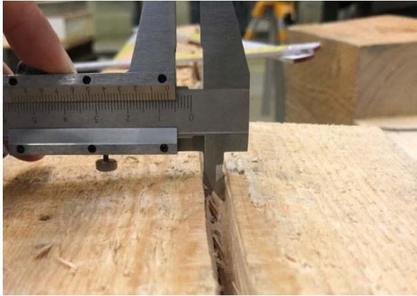
Obr. 26 - Šířka výsušné trhliny vzorku 2
