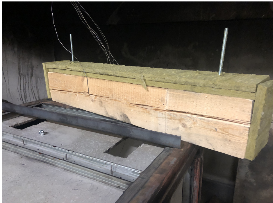
Obr. 35 – Obložení vzorku tepelnou izolací
