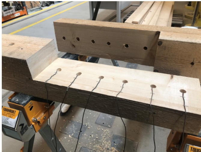
Obr. 29 – Umístění termočlánků v blízkosti spojovací prostředků ve spoji- Vzorek 1
