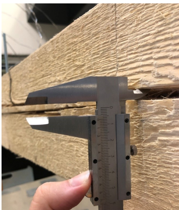
Obr. 25 – Šířka výsušné trhliny vzorku 1
