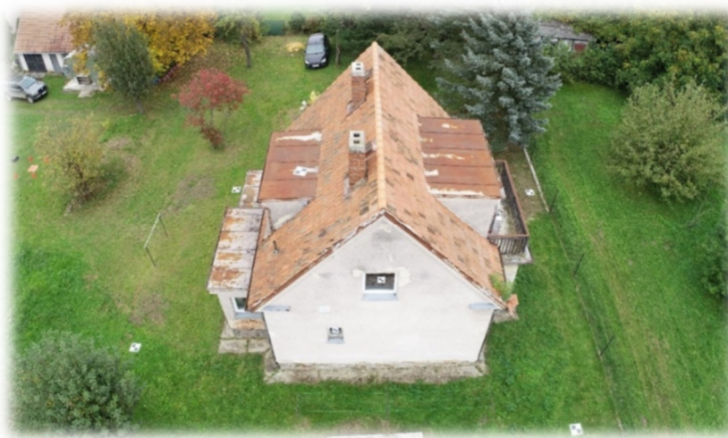
Obr. 16 Rozmístění vlíčovacích bodů
