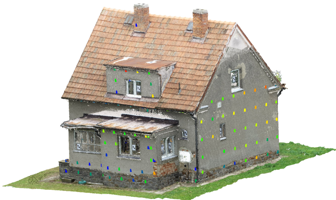
Obr. 44 Mračno bodů a přesnost kontrolních bodů stěn objektu – severovýchodní pohled
