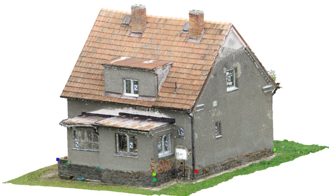
Obr. 49 Mračno bodů a přesnost kontrolních bodů rohů objektu – severovýchodní pohled
