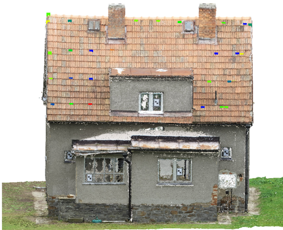
Obr. 47 Mračno bodů a přesnost kontrolních bodů střechy objektu
