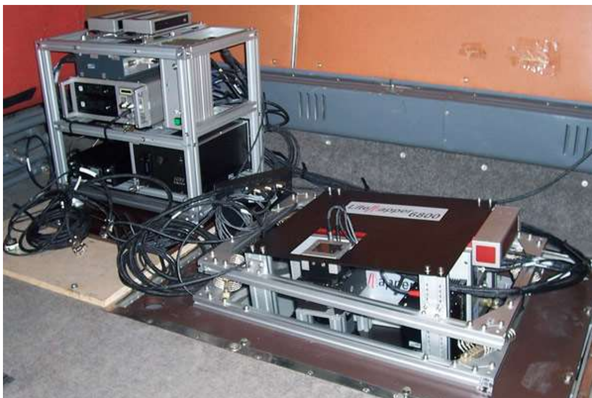
Obr. 2: Instalace systému LiteMapper 6800 v L-410FG (foto: Geoportál ČÚZK)
