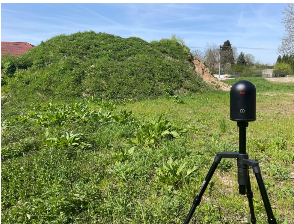
Obrázek 18: Skenování náspu skener Leica BLK 360
