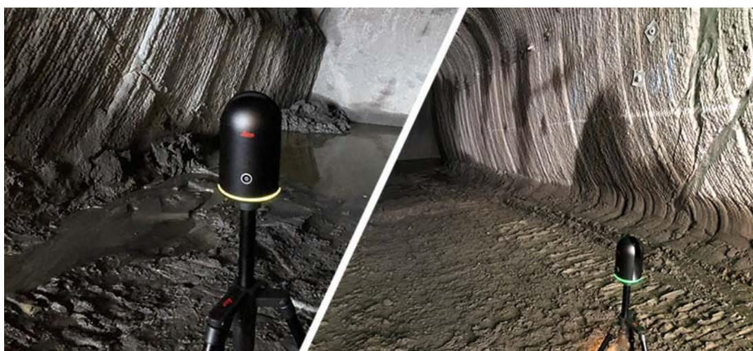
Obrázek 11: Skenování těžebního místa skenerem Leica BLK360 [10]
