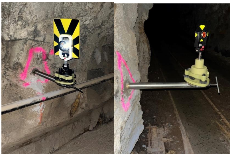
obr. 12: Trimble hranol VX/S a Leica minihranol GMP-101 [vlastní foto]
