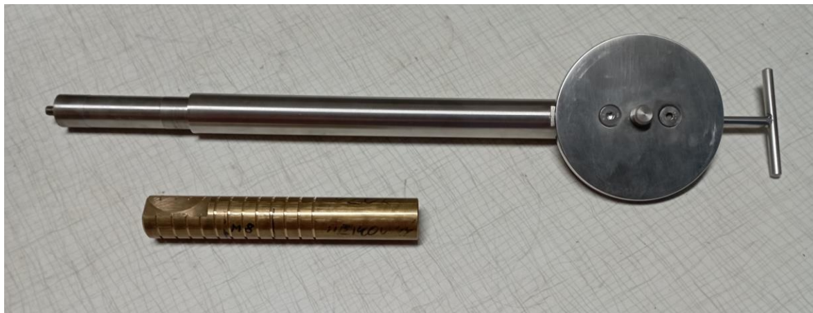
obr. 10: NCC „pádlo“ a zďěř pro zavrtání do stěny [vlastní foto]
