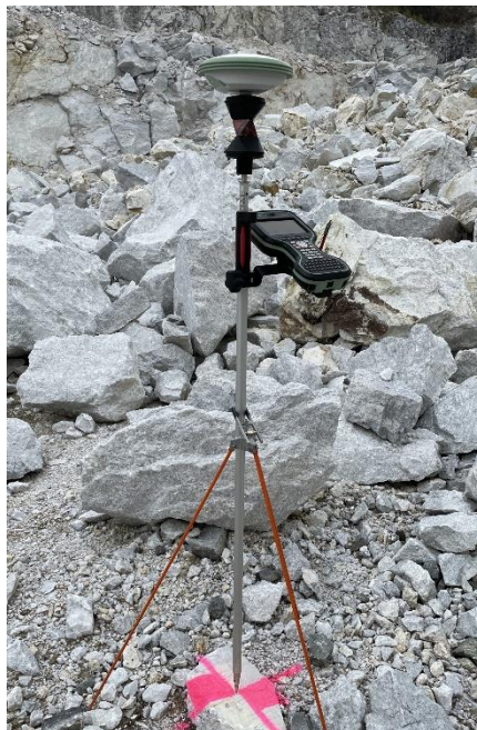
Obrázek 8: Část měřického systému Leica Captivate, skládající se antény GS07, kontroléru CS20 a odrazného hranolu GRZ122
