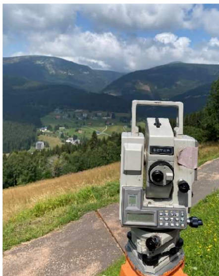
Obrázek 9 Elektronický teodolit SOKKIA SET4B při měření
