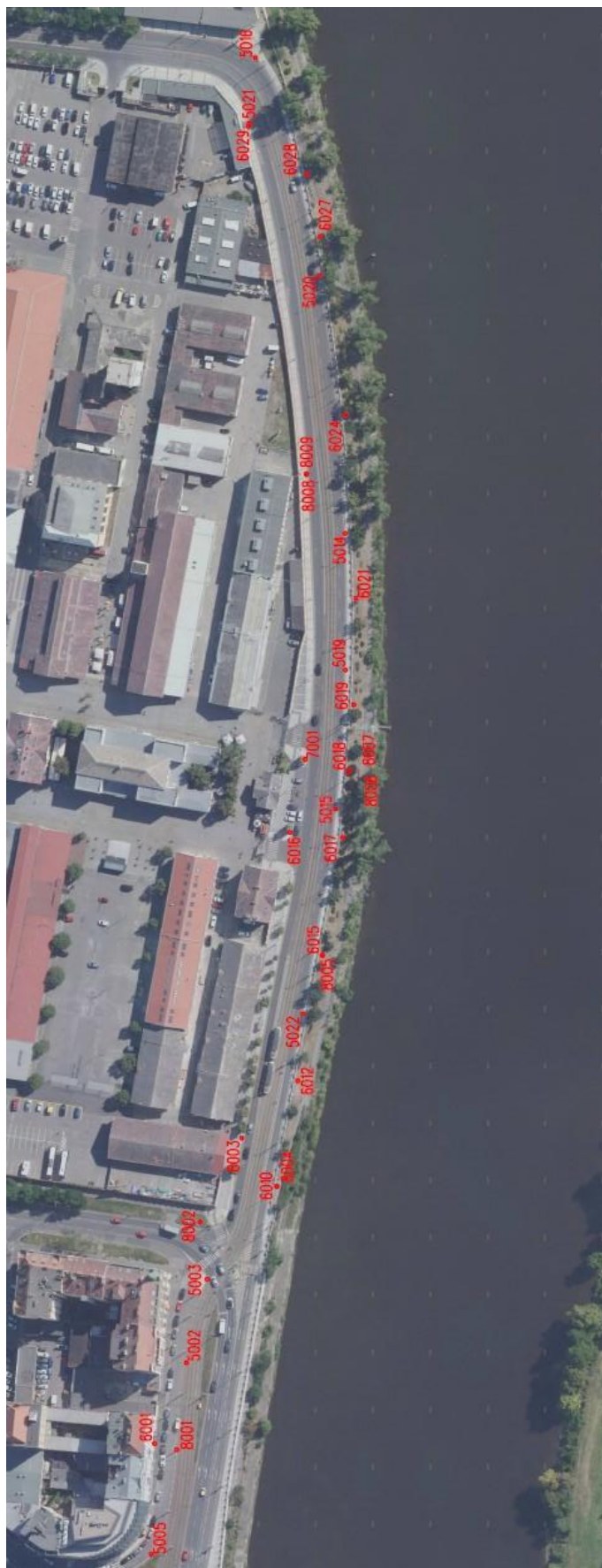
Obr. 10 – Přehledka primární a sekundární vtyčovací sítě
