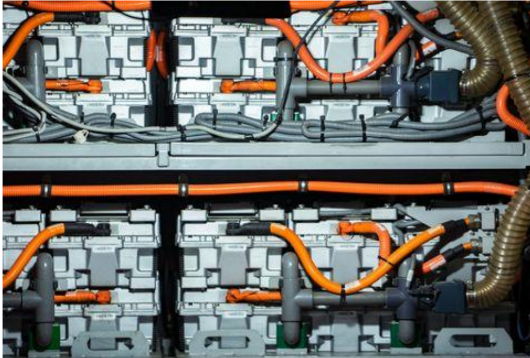
Obrázek 2.5: Ukázka lithium-iontové baterie elektromobilu [25]
