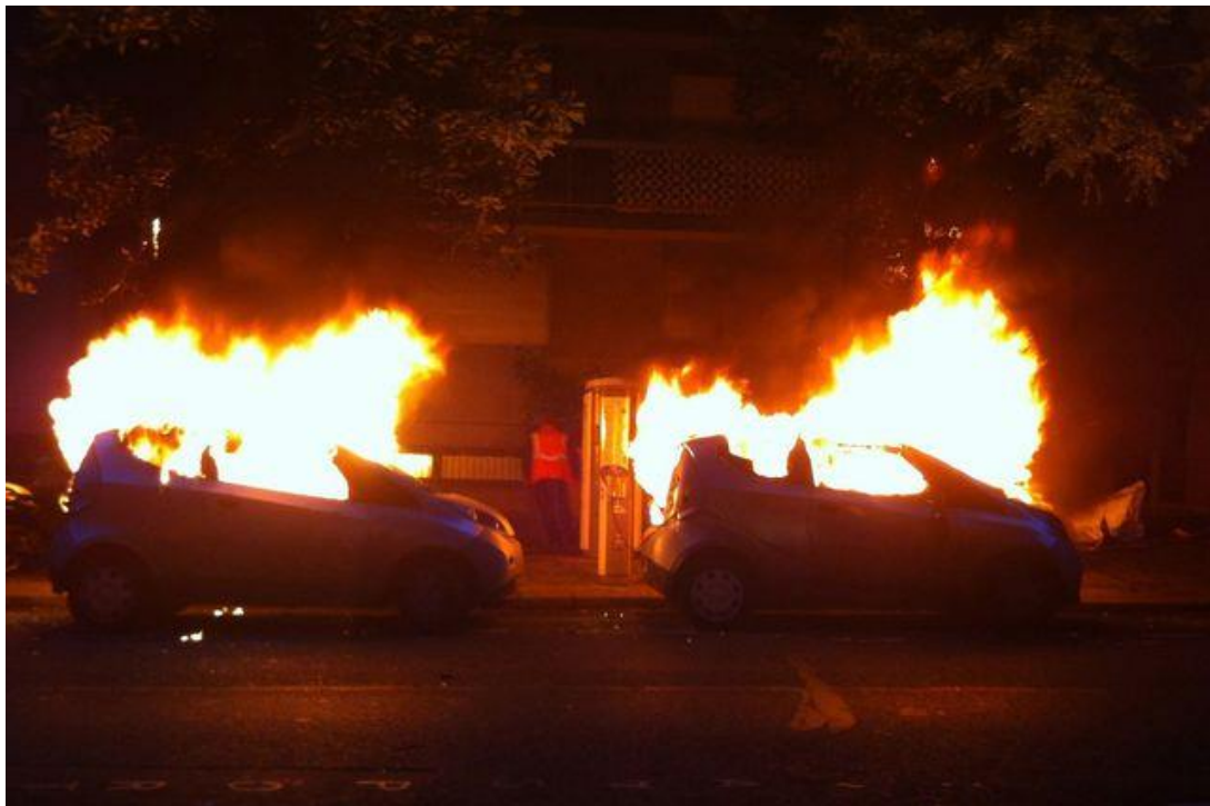
Obrázek 2.6: Požár elektromobilů při nabíjení [25]
