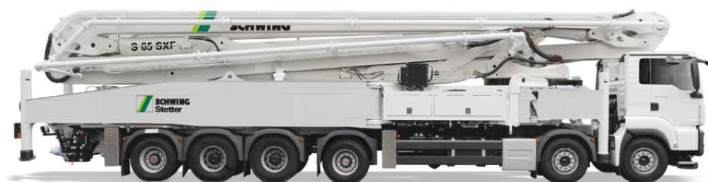
Obr. 7: Autočerpadlo Schwing S65 SXF [5]
