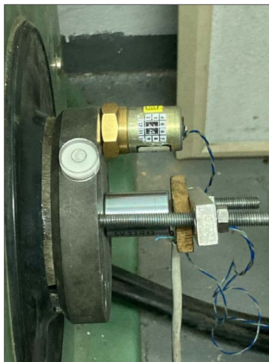
Obrázek 22: připojení snímače ke kalibračnímu zařízení, vlastní archiv
