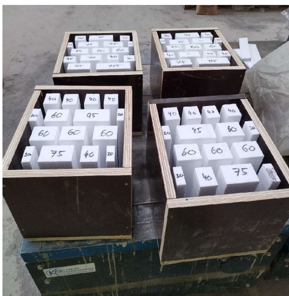
Obrázek 19: Připravené formy bednění
