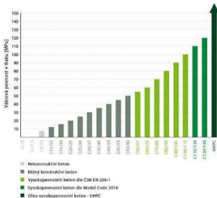
Obrázek 1: Rozdělení betonu podle pevnosti [5]
