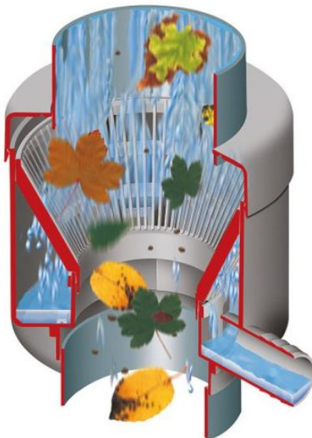
Obrázek 28 - Schéma možného principu funkce sběrače dešťové vody, zdroj: https://katalog.ambra.cz/sberac-destove-vody-graf-s-filtrem-hnedy-d92409.htm?gclid=CjwKCAjwrJ-hBhB7EiwAuyBVXf_3Bsuff5Uk-J-Y2BSOIYaAEtt4RlfH6EQoG3Jt37p_NudSk5eTjRoCJE8QAvD_BwE&cook=set
