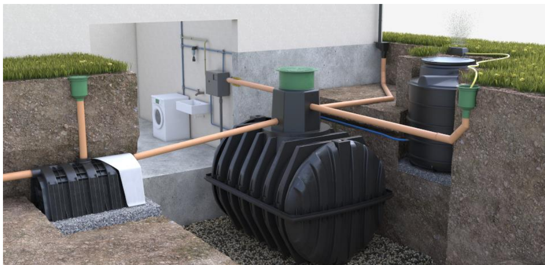
Obrázek 29 - Schéma funkce akumulční nádrže, zdroj: https://www.dek.cz/akce/detail/372-porovnani-retencnich-nadrzi-na-destovou-vodu-a-vybrane-sestavy
