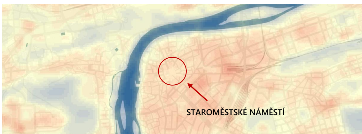
Obrázek 47 - Termokamerový snímek se zaměřením na historické centrum Prahy a Staroměstské náměstí, zdroj: https://app.iprpraha.cz/apl/app/ndvi_teplota/
