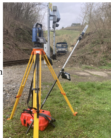
Obrázek 24: SOKKIA Fusion systém při měření.
