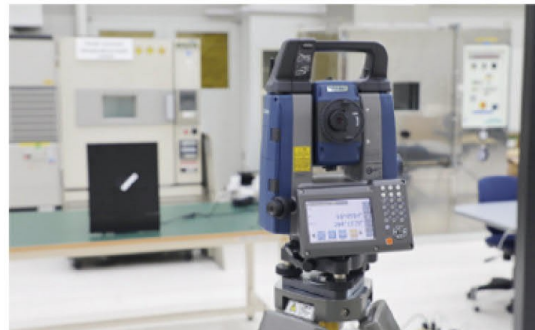
Test automatického sledování v podmínkách vysokorychlostních vibrací a proti otáčejícímu se objektu.
