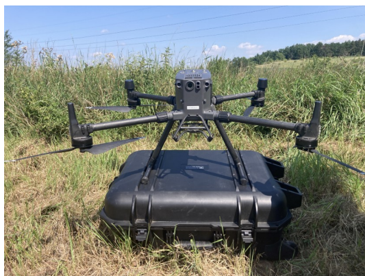
Obrázek 37: Dron DJI Matrice 300 připravená pro vložení P1 na stanovišti
