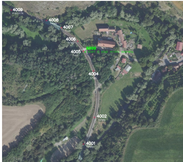
Obrázek 49: Bodové pole (vlivovací body) pro georeferencování GeoSLAM
