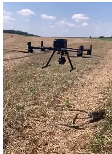
Obrázek 41: vzlet DJI Matrice 300 s L1 při měření
