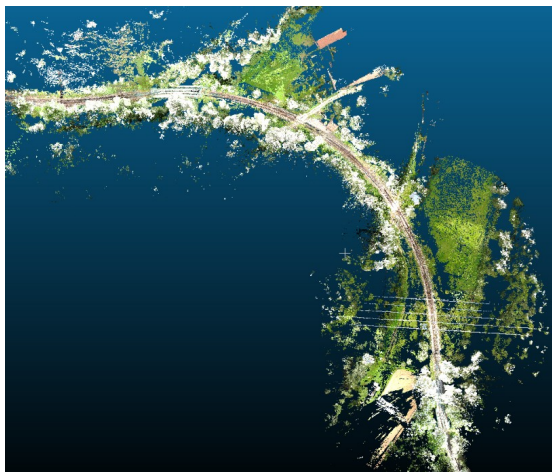
Obrázek 33: Ukázka surových spojených mračen bodů pořízených pomocí FARO Focus S 70
