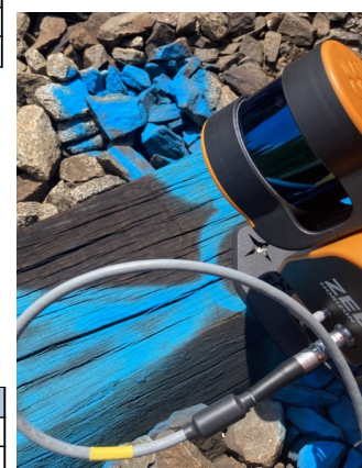
Obrázek 21: Ukázka měření pomocí mobilního skenování na vlícovacím bodu
