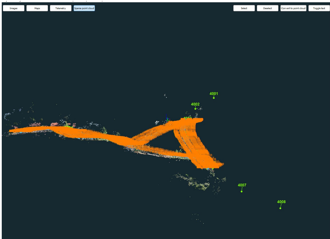
Obrázek 78: 3Dsurvey - hrubý výpočet mračna bodů z videogrammetrie
