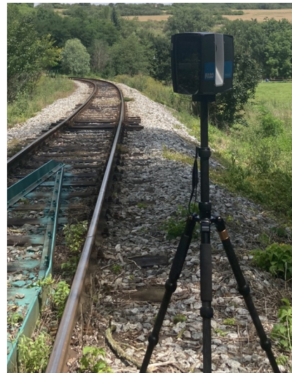
Obrázek 32: Ukázka měření statickým skenerem v terénu
