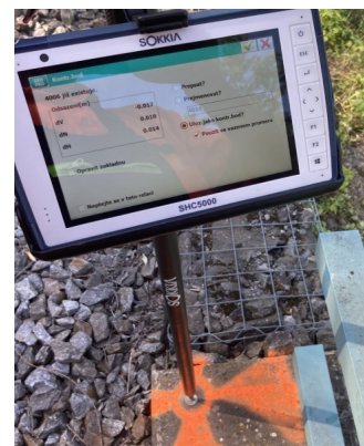
Obrázek 20: Záznam z dvojího měření bodového pole pomocí GNSS
