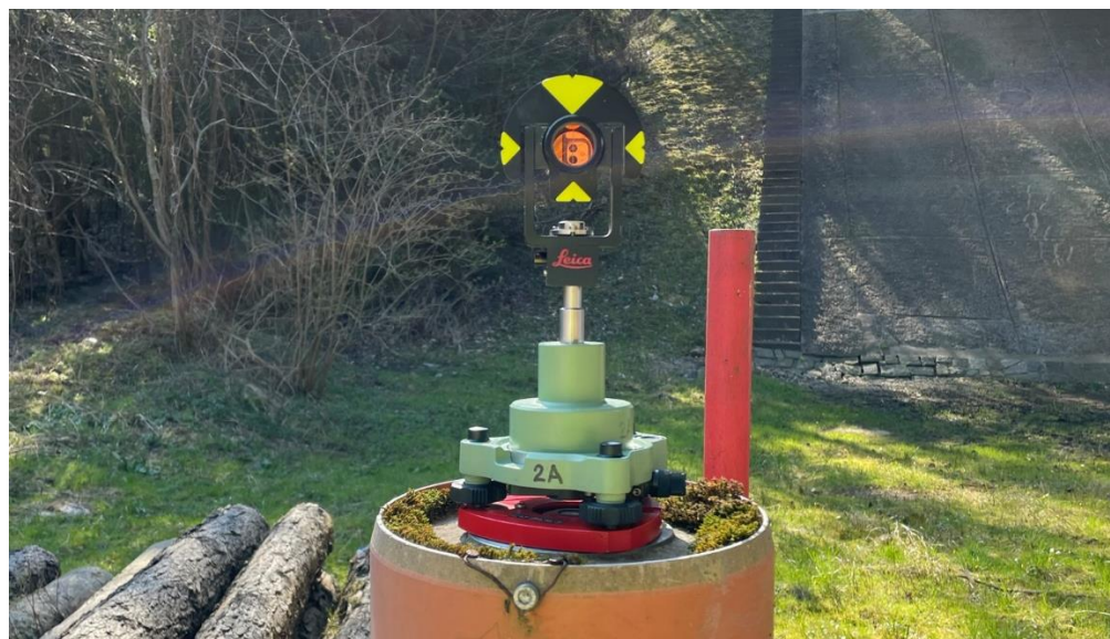
Obrázek 21: Leica mini-hranol na bodě č. 5 [vlastní zpracování]
