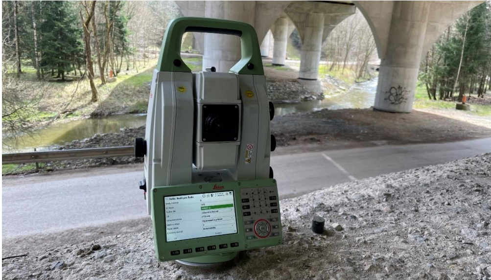
Obrázek 19: TS Leica Nova TS60 na nově stabilizovaném bodě č. 1 [vlastní zpracování]
