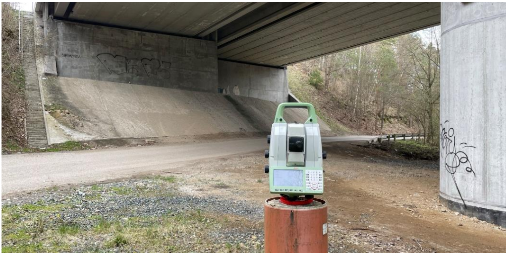
Obrázek 20: TS Leica Nova TS60 na bodě č. 4 [vlastní zpracování]
