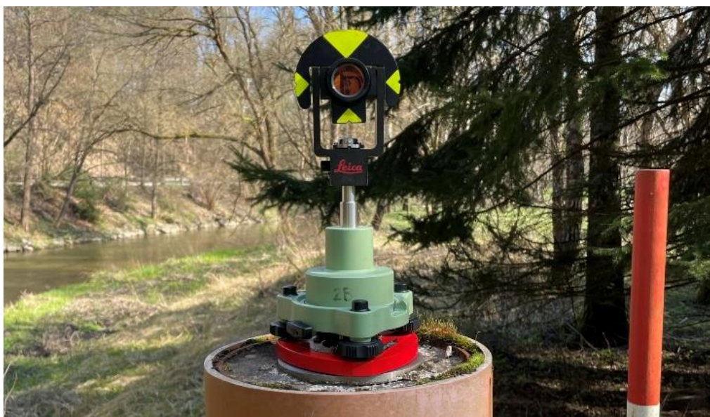
Obrázek 18: Leica mini-branch na bodě č. 3 [vlastní zpracování]
