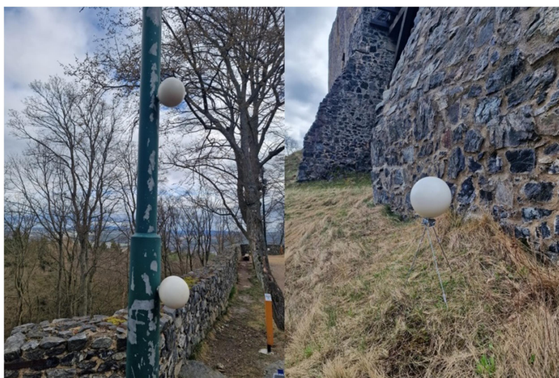
Obr. 16: Kulové terče Leica – Ø145 mm (vlevo) a Ø200 mm (vpravo)
