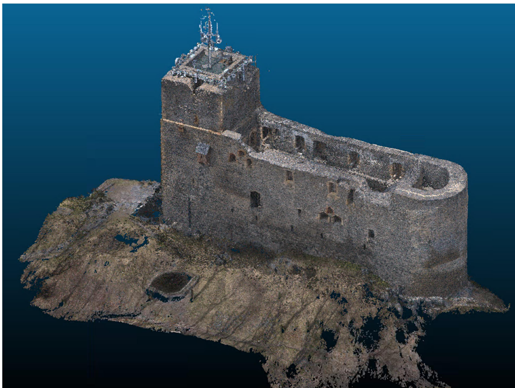
Obr. 22: Kompletní mračno bodů z letecké FTGM (SW CloudCompare)
