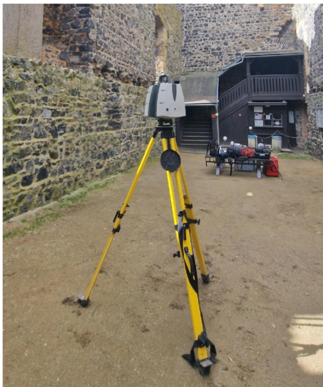
Obr. 15: 3D laserový skener Leica ScanStation P40 - měření na nádvoří hradu Radyně
