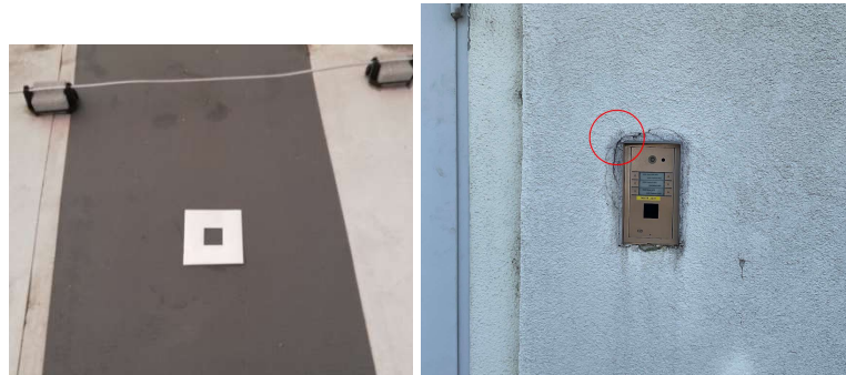
Obr. 1 – Signalizace kontrolních bodů (hliníková značka – v levo, výrazný prvek – v pravo)
