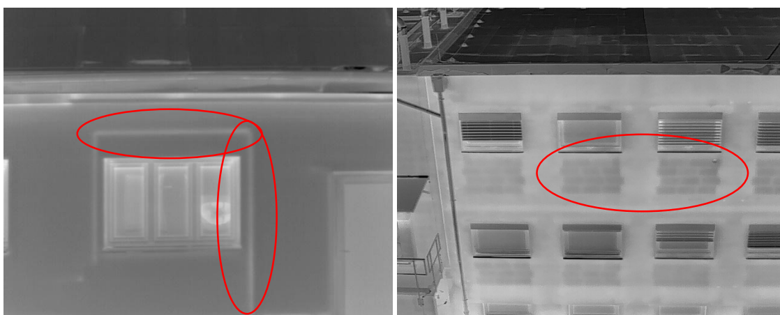
Obr. 30 – Příklady úniků tepla u areálu [vlastní zdroj]
