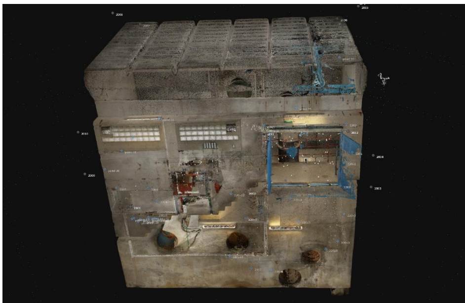
Obr. 26: RealityCapture – husté mračno bodů interiéru
