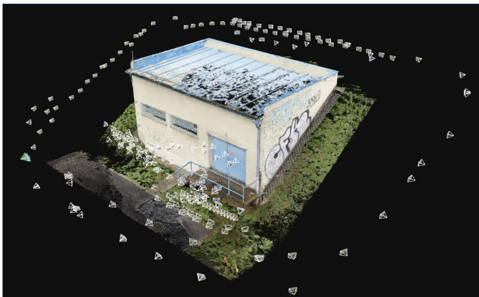
Obr. 27: RealityCapture – husté mračno bodů exteriéru
