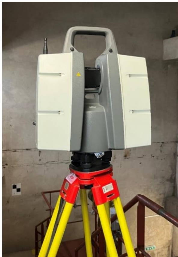
Obr. 17: Zaměření armaturní komory laserovým skenerem
