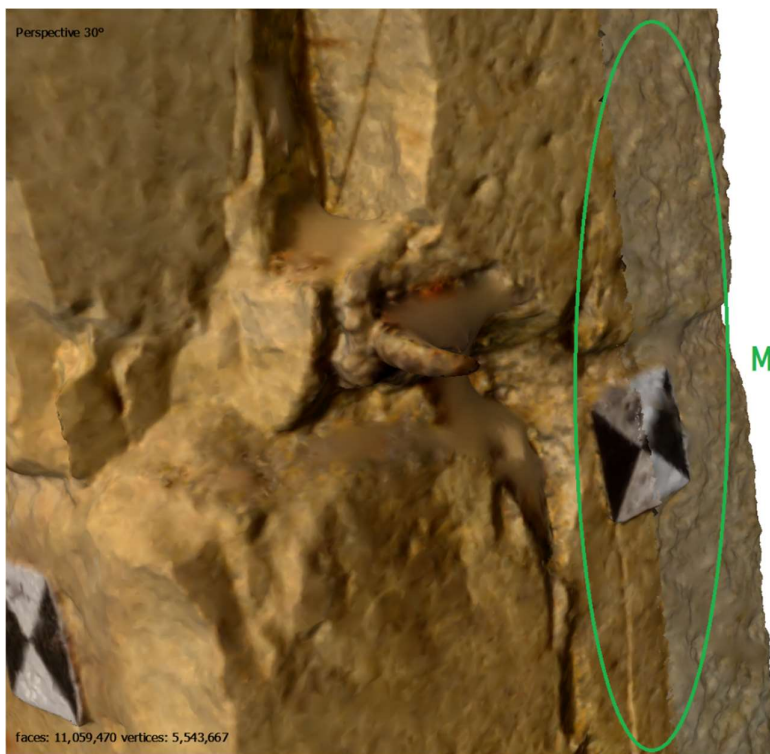
Obr. 56 Spojení modelů v místech vřícovacích bodů
